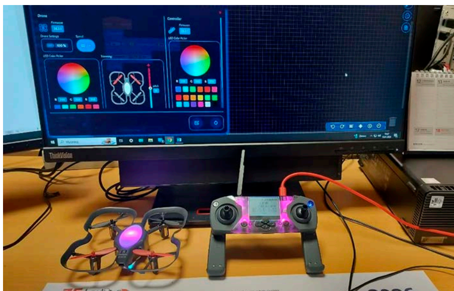
Ilustracja 10. Kontroler połączony do komputera oraz sparowany dron z włączonym oknem właściwości
